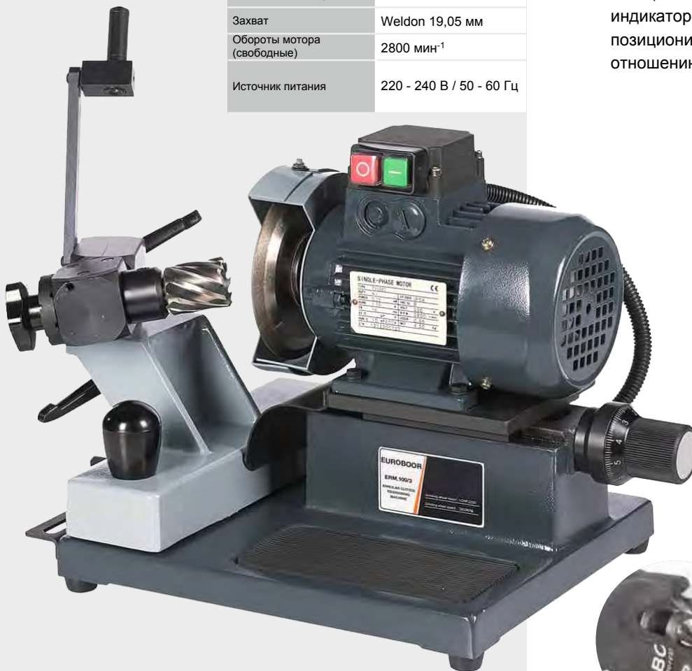
Положение кольцевого сверла у лезвия, для заточки
