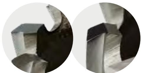
Кольцевые сверла HSS имеют 2 вида зубьев с разными углами заточки
